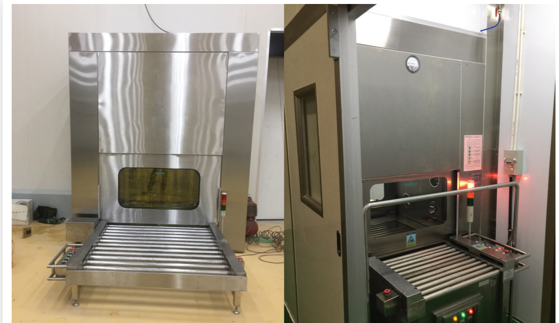
PASSBOX AIR SHOWER KÈM THEO BĂNG TẢI - PASS BOX AIR SHOWER CONVEYOR
